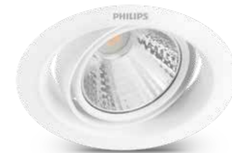
59554 POMERON DIM 070 3W 40K EU RECESSED 5955431000 8718696173787 ↳ 90 I 67 mm (výřez Ø70 mm) 3 W, 210 lm při 4000 K
